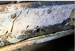
En la Figura 3 del Catálogo Ilustrado de Partes (CIP) de la aeronave, se puede observar, tal como se ve en el extracto de la mencionada figura adjunto a la derecha, que el Perfil "J" inferior, es el ítem N° 28, P/N 61229-00, denominado SECTION — Wing walk "J". Esta parte, si bien no se detalla en el CIP, va fijada del lado trasero del larguero delantero, debajo de la PEDANA. La fijación al larguero es mediante tornillos a la pestaña vertical de la Platabanda inferior del Larguero.
