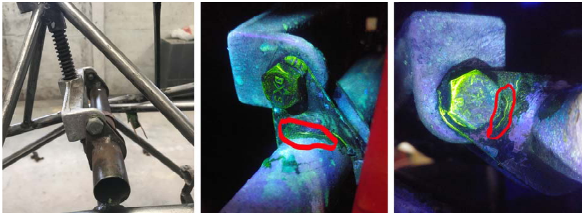
Fig. 4 – Daños detectados en la toma delantera del estabilizador
