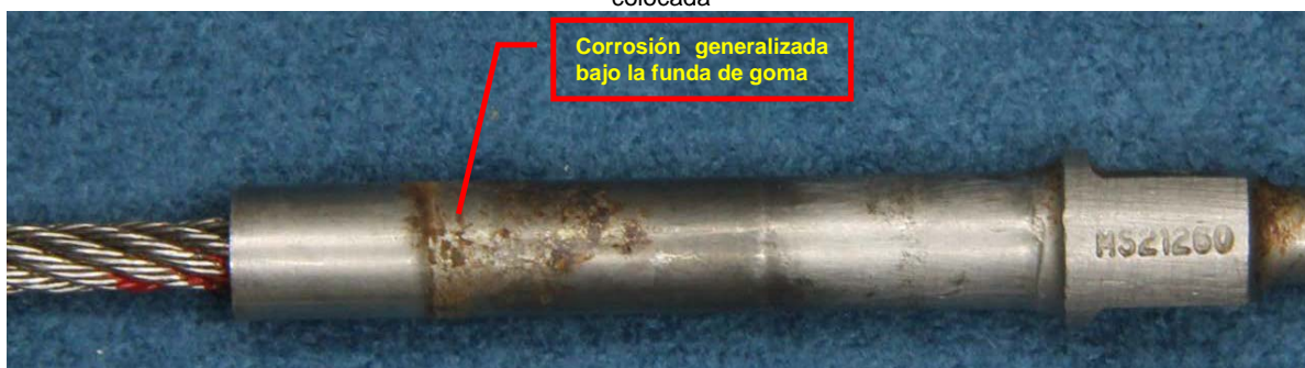
Herraje Terminal de cable de comando con la funda de goma removida
